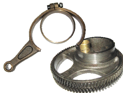
veliki zazor, između oštećene glavčine (rukavca integrisanog sa zupčanicom) i bronzanog ležaja u velikoj pesnici, do- vodi do loma klipnjače.
